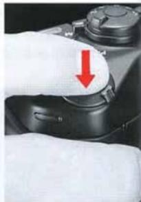
4. Contrôlez l'apparition du témoin de mise au point correcte dans le viseur puis sollicitez franchement le déclencheur.
