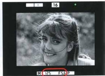
2. Sollicitez légèrement le déclencheur et vérifiez l'exposition dans le viseur.
