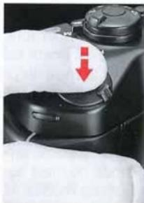
2. Avez les repères de mise au point du viseur sur le sujet principal puis sollicitez légèrement le déclencheur.
