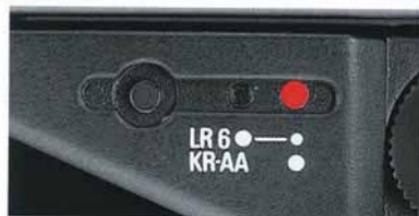
Si un seul indicateur par DEL s'allume, remplacer les piles.
