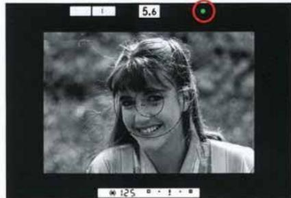
En mode de mise au point manuelle, tournez la bague de mise au point de l'objectif jusqu'à ce que l'image apparaisse nette dans le viseur et/ou que le témoin électronique de mise au point correcte (●) apparaisse.
