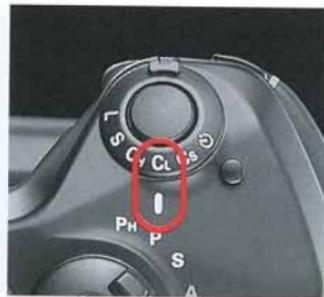
1. Réglez le sélecteur de mode de mise au point sur C et choisissez le mode d'entraînement C<sub>L</sub>.
