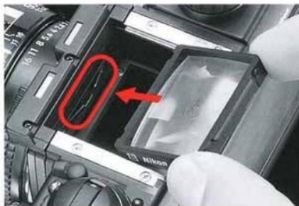
Pour placer un nouveau verre, glissez simplement le bord avant sous la lamelle centrale et poussez la face arrière pour la mise en place.
