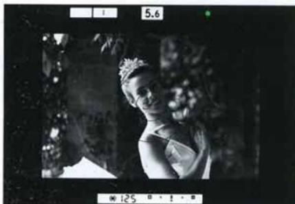
2. Assurez-vous que la DEL témoin de mise au point correcte apparaisse dans le viseur.
