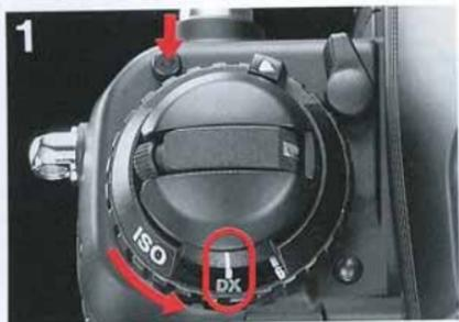
1 Avec les films codés DX: appuyez sur le bouton de déverrouillage et amenez le sélecteur de sensibilité du film sur la position DX.
