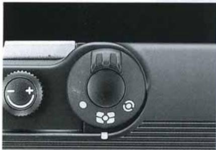
Le F4 propose trois types de mesure: matricielle, centrée (pondération centrale 60/40) et spot. Avec le viseur multi-mesure DP-20, équipement standard du F4, vous choisissez l'une de ces options en positionnant le sélecteur du viseur sur (☒) pour matricielle, (●) pour centrée et (•) pour spot.
