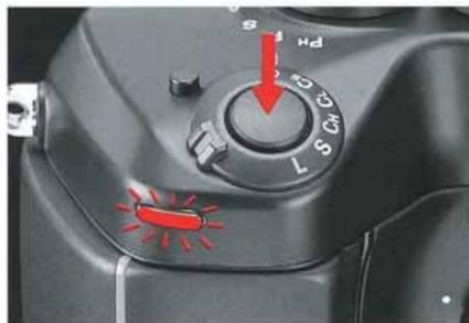
L'utilisation du retardateur de 10 secondes active la mise au point automatique et la mesure de la lumière.
