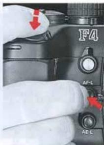
2. Sans relâcher le déclencheur, vérifiez l'apparition de la DEL témoin de mise au point correcte soit allumée puis appuyez sur la commande AF-L et maintenez-la.
