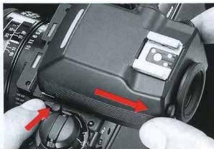
Pour dissocier le viseur, poussez le levier de verrouillage en direction du viseur et, simultanément tout en tenant le viseur, tirez ce dernier vers l'arrière, c'est à dire en direction opposée à celle de l'objectif.
