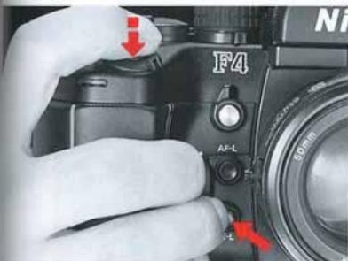
4. Sans relâcher la pression sur le déclencheur, pressez la commande AE-L et maintenez-la.
