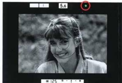
En mode de mise au point automatique, axez la zone de sensibilité du télémètre électronique sur le sujet, sollicitez légèrement le déclencheur et assurez-vous que le témoin de mise au point correcte DEL (●) se soit allumé dans le viseur (en mode suivi automatique, la DEL n'apparaît pas; voir page 37).
