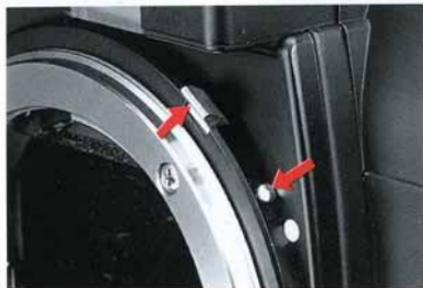
Avant de monter un objectif non-AI, n'oubliez pas d'appuyer sur le poussoir de déverrouillage du levier de couplage du posemètre et de mettre ce levier en position haute. Vous pourrez alors opérer à ouverture réelle (voir page 59). Une mesure d'exposition à ouverture réelle ne peut être effectuée en mesure spot.
