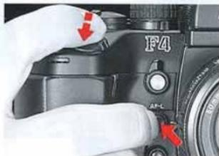
Le recours simultané à la mémorisation de l'exposition par la commande AE-L est recommandé, il vous suffit de placer la commande de couplage des fonctions AF-L et AE-L sur la position (●●) et d'appuyer sur AF-L.
