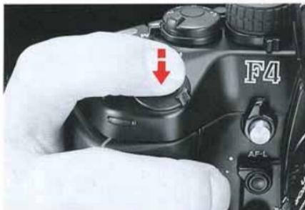
3. Pressez légèrement le déclencheur pour activer la fonction de mise au point automatique.
