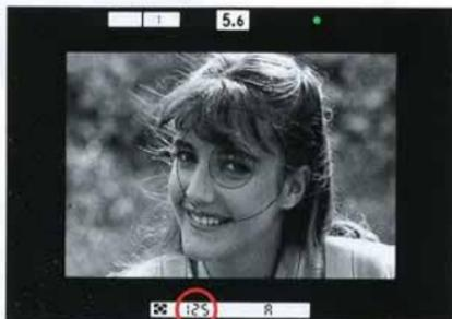
2. Sollicitez légèrement le déclencheur et contrôlez l'exposition dans le viseur.
