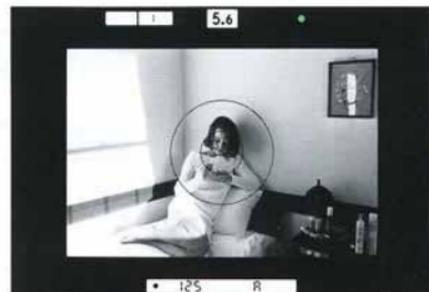
3. Sollicitez légèrement le déclencheur, vérifiez l'ouverture et la vitesse indiquées dans le viseur.
