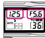
**CUSTOM 8** : Il est possible de programmer une temporisation différente pour l'extinction automatique du système de mesure à 3, 10 ou 20 sec. (p. 75).
