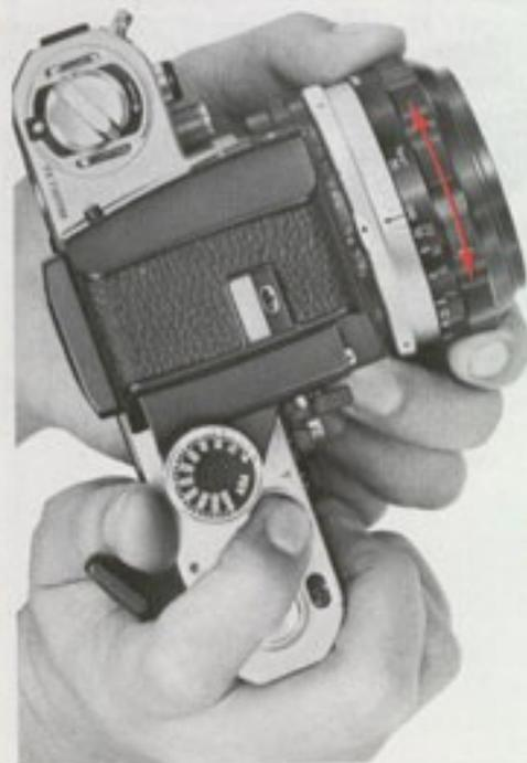
Avec les objectifs Nikkor Auto, la mise au point s'effectue toujours à pleine ouverture. Ceci permet d'obtenir l'image la plus lumineuse sur le verre de visée, ce qui est important dans la précision de la mise au point et du cadrage. En outre, la profondeur de champ s'en trouve diminuée, ce qui offre le maximum d'assurance d'avoir la netteté sur le plan désiré.
