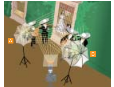
Le flash SB-800 primaire connecté au F6 est équipé d'un filtre de couleur orange pour les éclairages frontaux. Chacun des deux flashes SB-800 du groupe A est équipé d'un Dôme de diffusion SW-10H et éclaire la dame au balcon, tandis que les deux flashes SB-800s du groupe B sont équipés de filtres de couleur orange pour éclairer les mariachis sur la droite.
